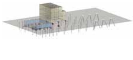
Schematische Darstellung des Aufbaus der Station. Sie besteht im Kern aus Stahlcontainern, die komplett ausgestattet angeliefert werden.
